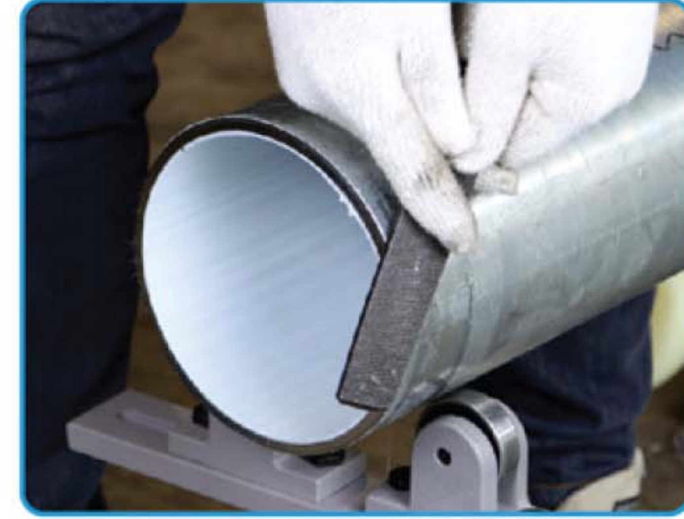
การตะไบลบคมขอบผิวท่อเหล็ก
